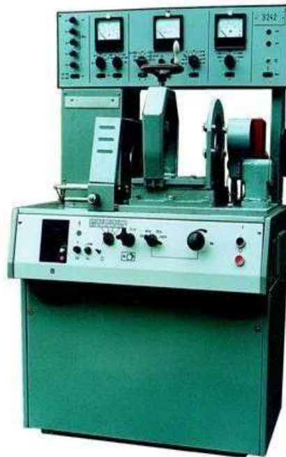
Рисунок 3 – Електричний стенд для перевірки генераторів та стартерів Е-242 «Цей стенд призначений для контролю та ремонту:
