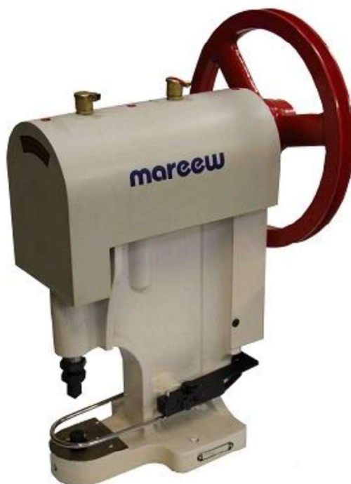
Рисунок 1.1 - Прес для установки фурнітури Mareew ML 808
