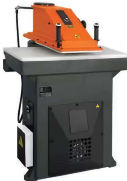
Рисунок 1.3 – Гідравлічний прес з поворотною траверсою
