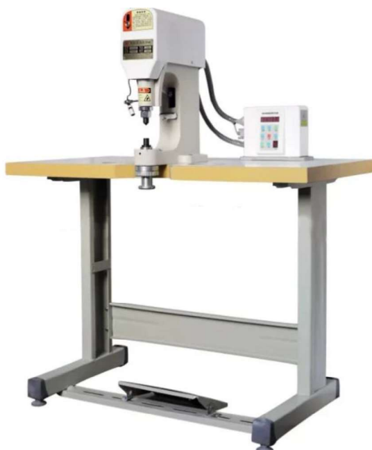
Рисунок 1.4 - Електромагнітний прес для встановлення металофурнітури
