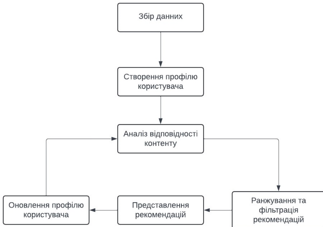
Рисунок 2.1 – Загальна схема роботи рекомендаційного методу на основі контентного фільтрування.
