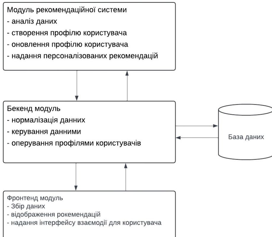
Рисунок 2.5 – Узагальнюючу схему функціонування модулів системи
