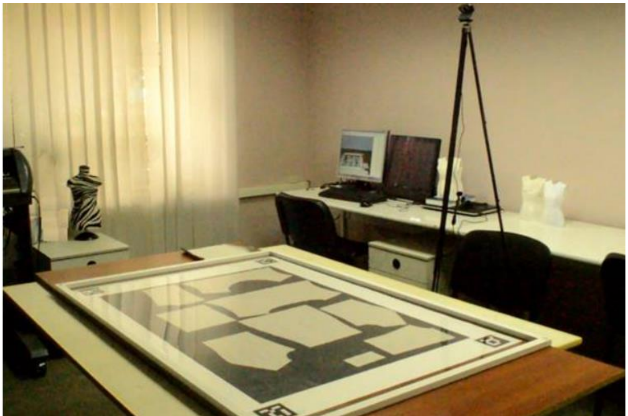
Рисунок 2.14 – Дігітайзер для розпізнавання контурів лекал та введення їх у систему [44]
