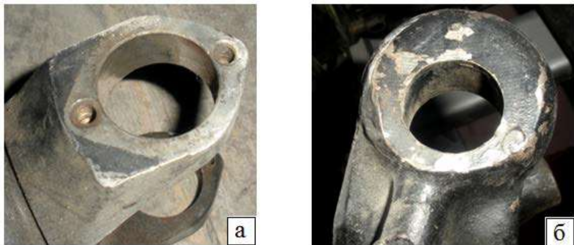
Рисунок 3.5 – Деталі, що мають еліпсне зношування отвору: а) фрагмент вилки карданної передачі; б) фрагмент поворотного кулака автомобіля КамАЗ
