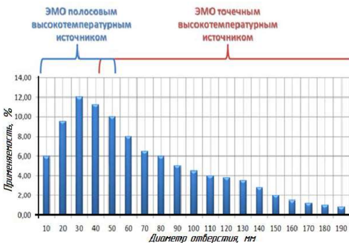
Рисунок 3.7 – Діапазон раціонального використання технологій ЕМО стосовно обробки отворів деталей машин
