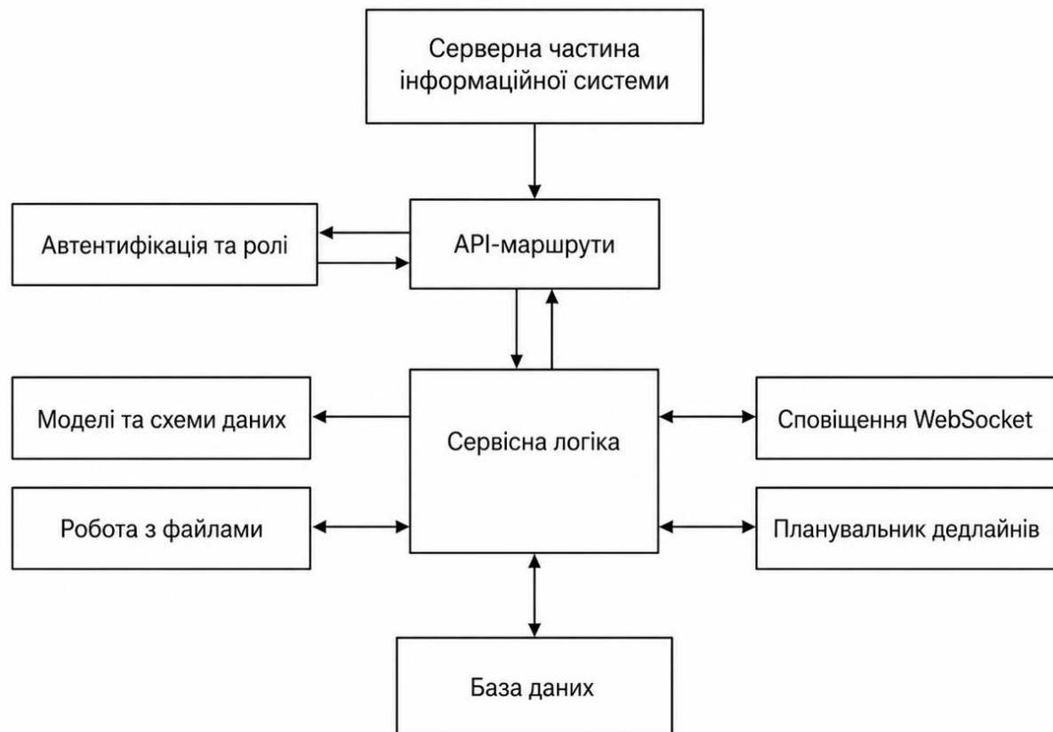
Рисунок 3.1 – Структура серверної частини інформаційної системи
