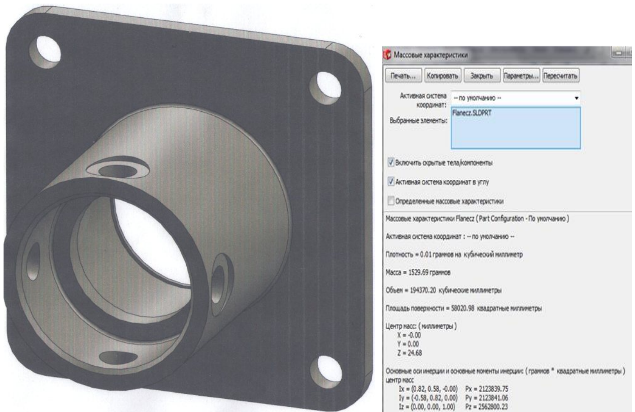
Рис. 2.5 – 3D модель деталі та масові характеристики
