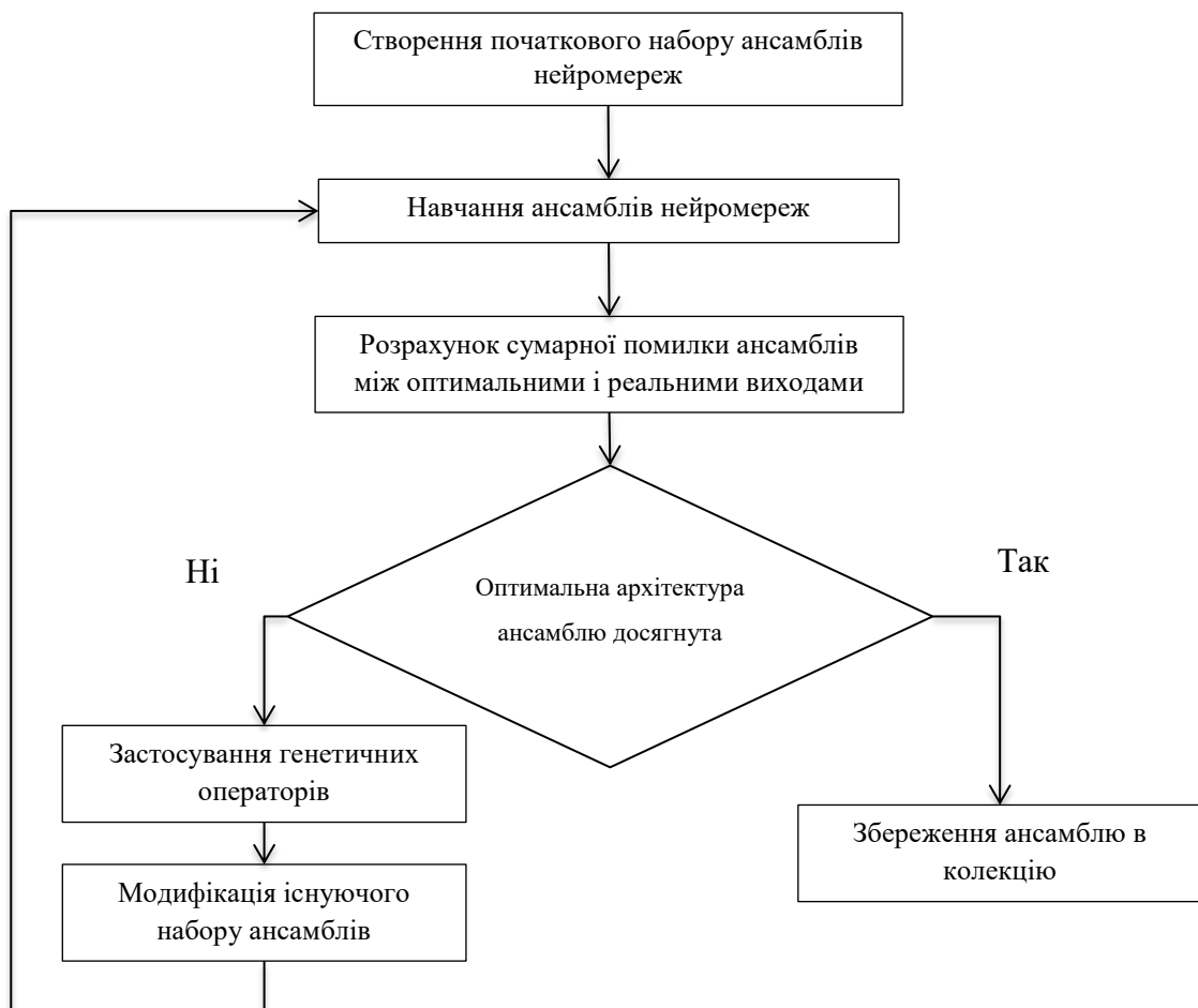
Рисунок 1.9 – Алгоритм підходу використання генетичних алгоритмів для дослідження ефективності використання ансамблів нейронних мереж
