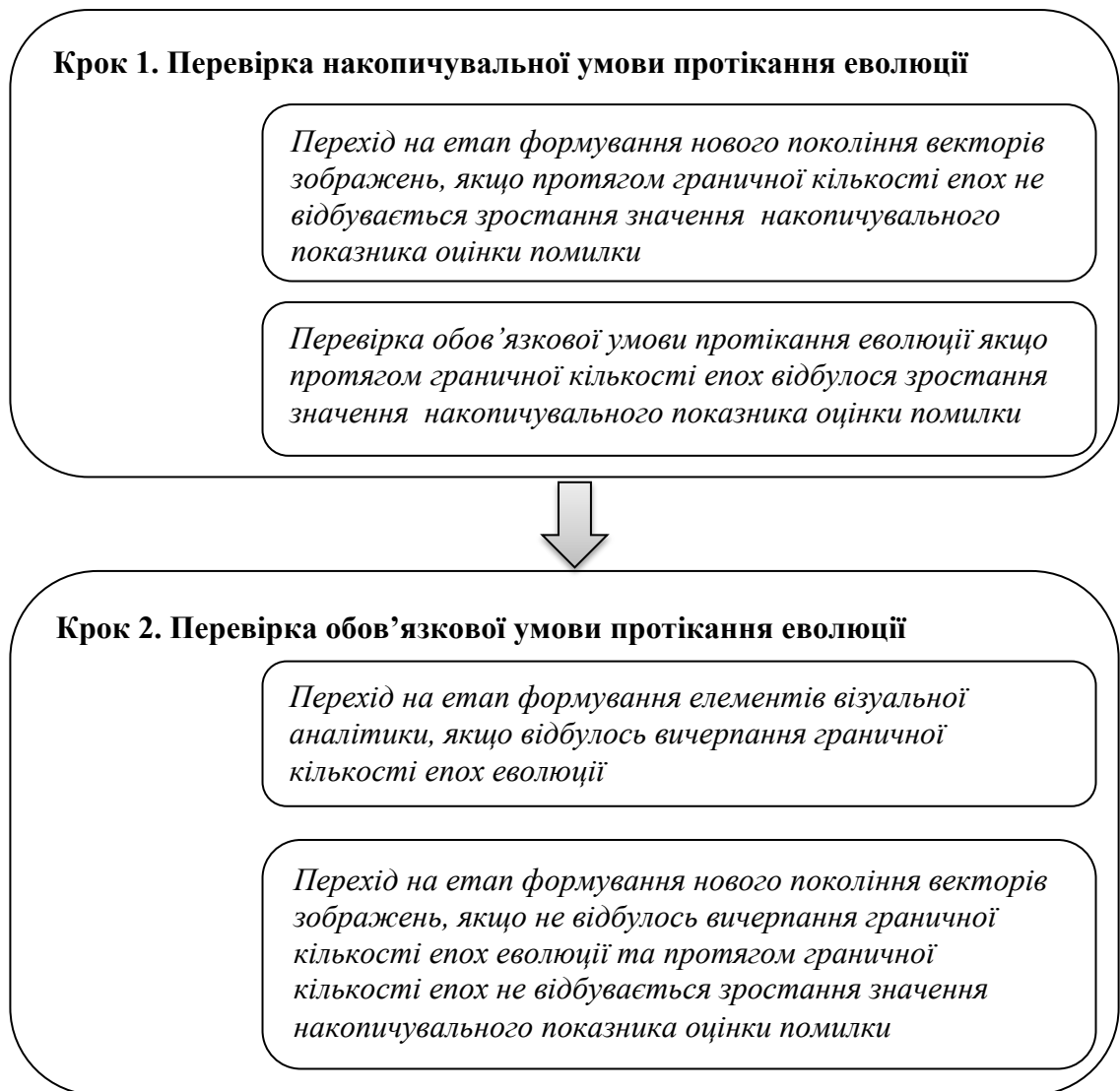
Рисунок 2.5 – Схема етапу перевірки умов завершення еволюції методу оцінювання ефективності нейронних мереж різних типів за допомогою генетичного алгоритму з використанням візуальної аналітики
