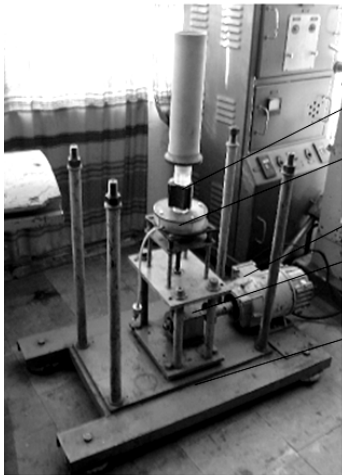
Рис. 1. Загальний вигляд експериментальної кавітаційно-магнітної установки
