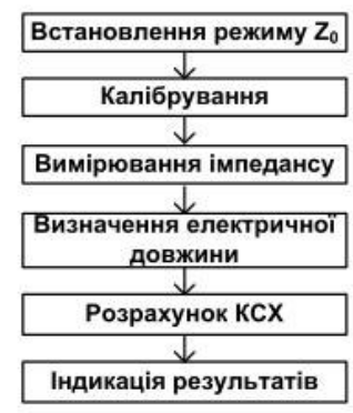
Фіг.4.1 – Структурна схема однозондового вимірювача КСХ
