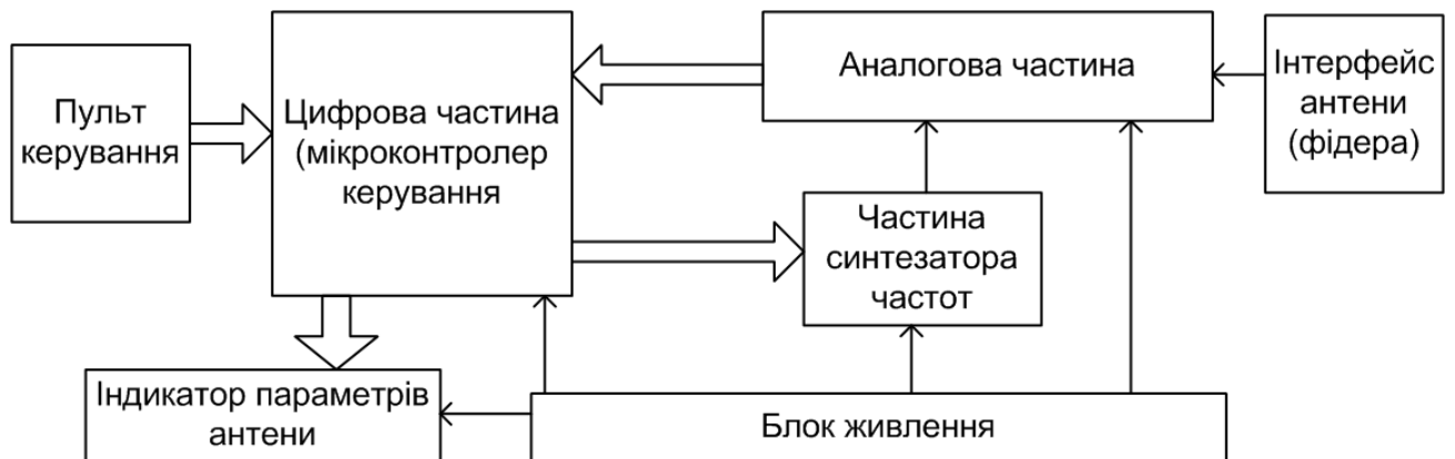
Рисунок 16 – Укрупнена схема взаємодії частин вимірювача
