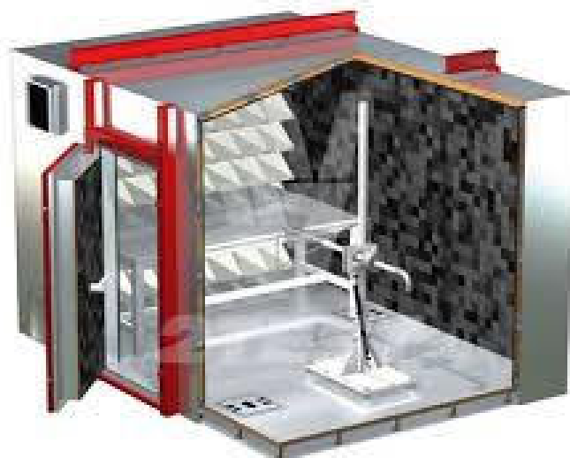
Рисунок 2- Камера для вимірювання діаграми спрямованості антенних систем
