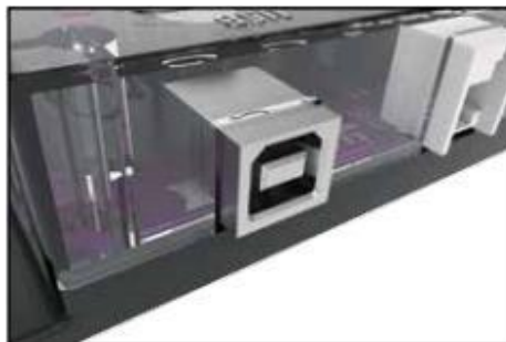
Рисунок 1.11 - Порт USB на контролері PRIZM, призначений для програмування та зв'язку
