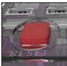
Рисунок 1.12 - Кнопка скидання параметрів на контролері PRIZM
