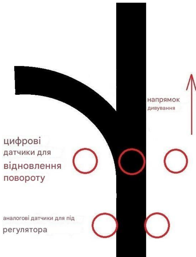
Рисунок 3.2 - Розташування інфрачервоних датчиків лінії
