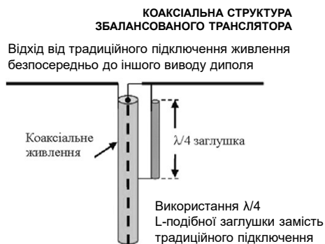
Рис. 8 – Конфігурація збалансованого транслятора
