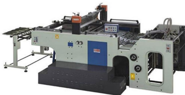
Рисунок 1.10 – Листовий ротаційний трафаретний верстат
