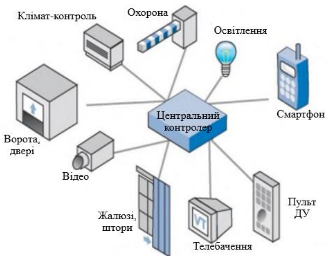
Рисунок 4.3 - Центральний контролер та виконавчі елементи
