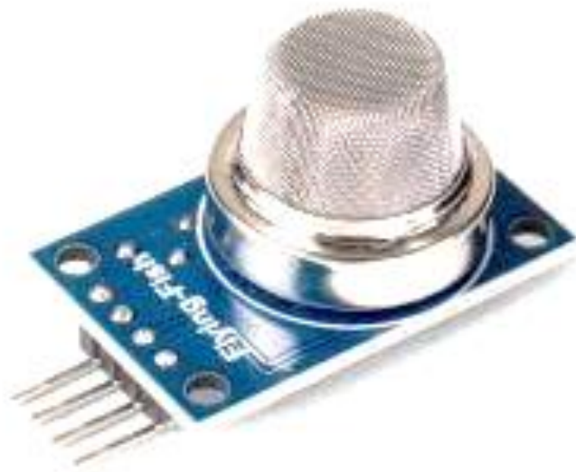
Рисунок 2.2 – Датчик диму типу MQ-2
