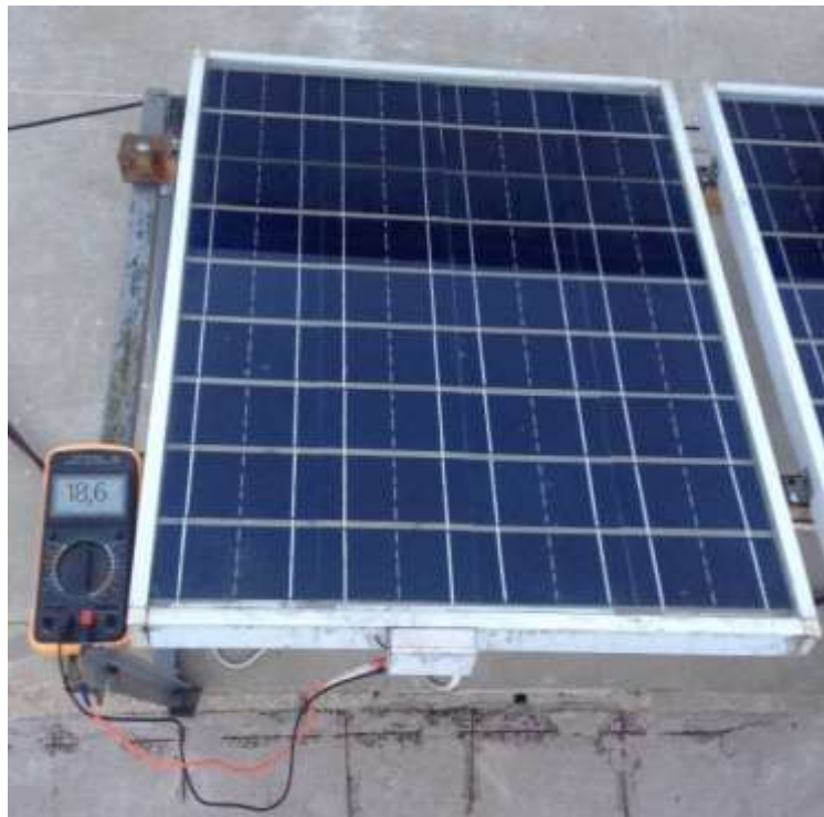
Рисунок 4.1 - Вимірювання напругу при максимальній потужності
