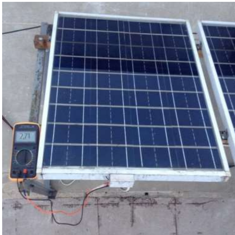
Рисунок 4.2 - Вимірювання струму при максимальній потужності
