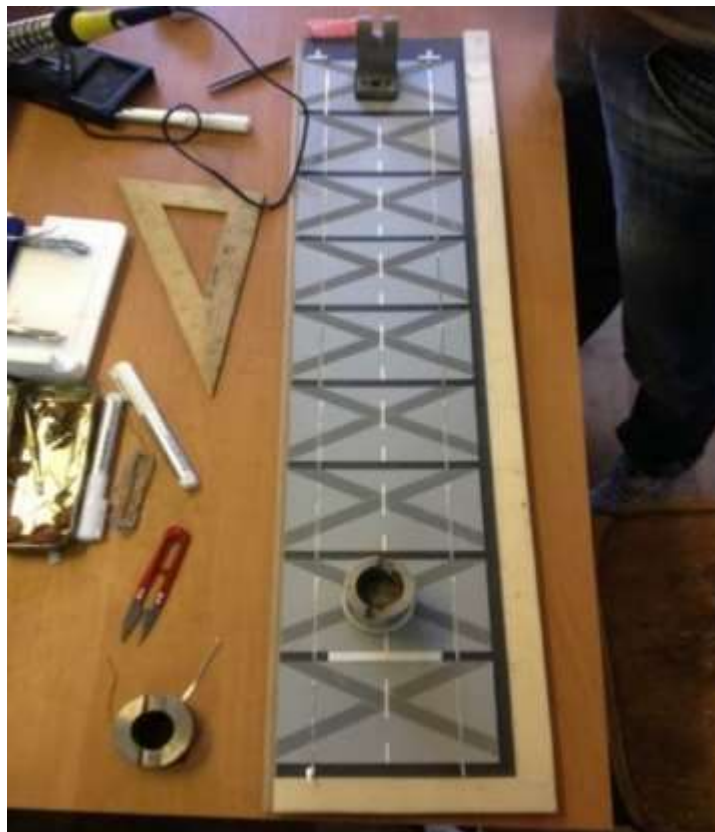
Рисунок 3.11 - Стрічка, яка складається з послідовно спаяних 9 елементів
