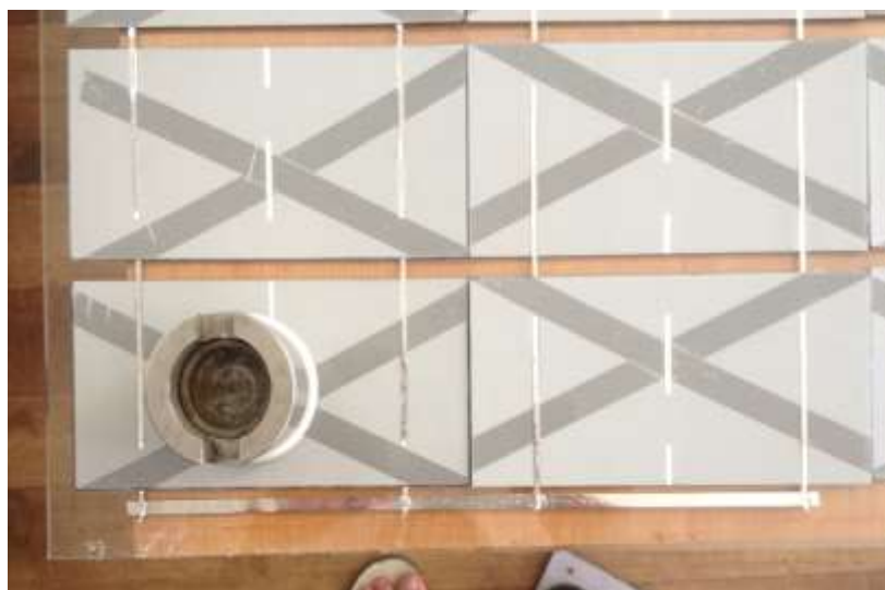
Рисунок 3.14 - Паралельно спаяні стрічки по 9 елементів
