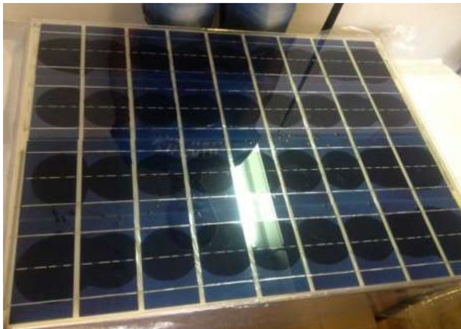
Рисунок 3.18 – Герметичне заливання елементів корпускулянтom (спеціальний силікон)
