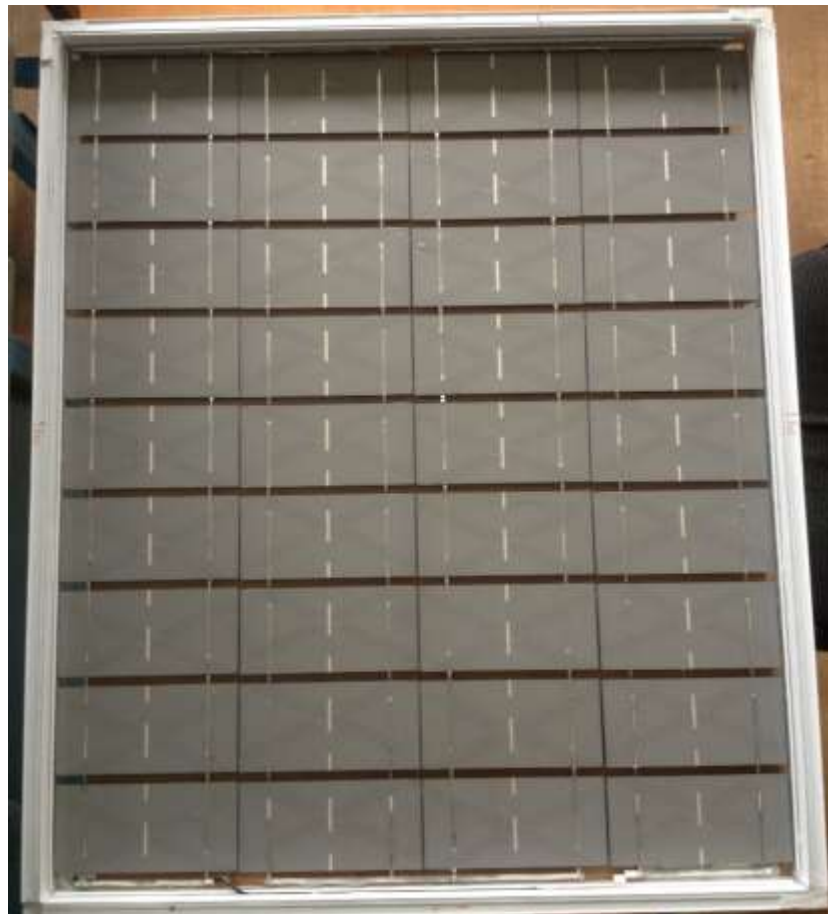
Рисунок 3.20 – Герметично залиті сонячні елементи в пластмасовій рамці
