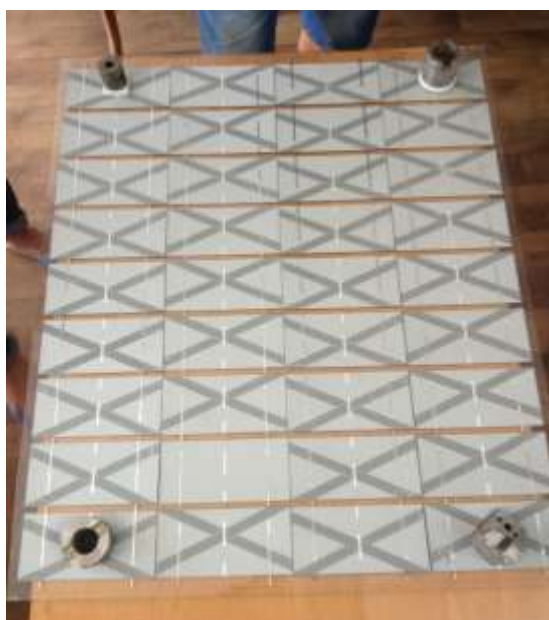
Рисунок 3.15 - Кінцевий вигляд паралельно спаяних між собою 9 стрічок
