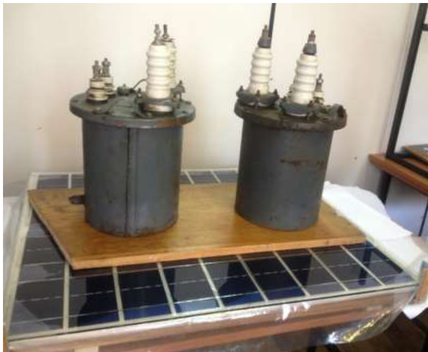
Рисунок 3.19 – Розподілення вантажа для герметичного заливання сонячних елементів
