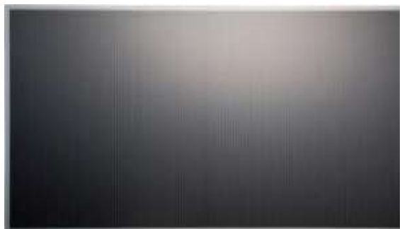
Рисунок 1.7 - Сонячний елемент на основі телуриду кадмію
