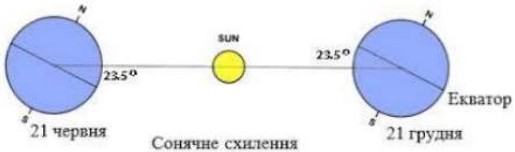
Рисунок 1.5 – Кут сонячного схилення
