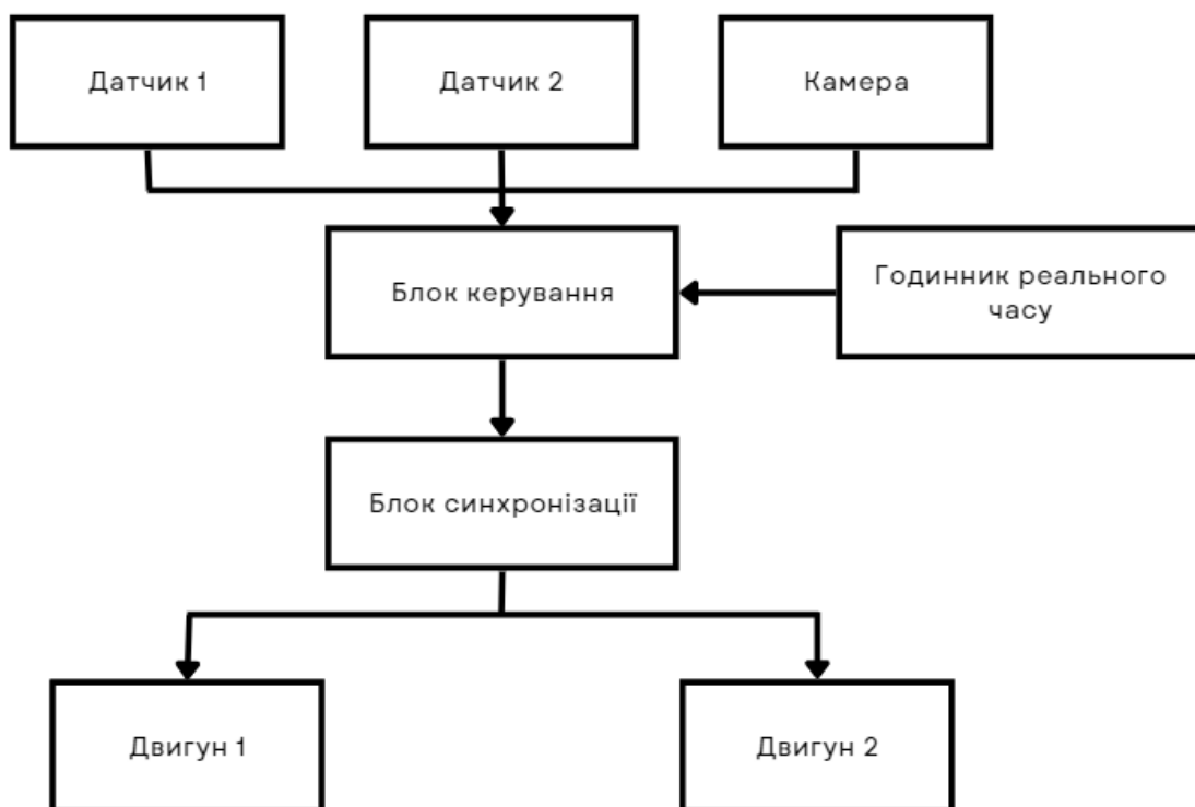
Рисунок 2.2 – Структурна схема пристрою слідкування за сонцем
