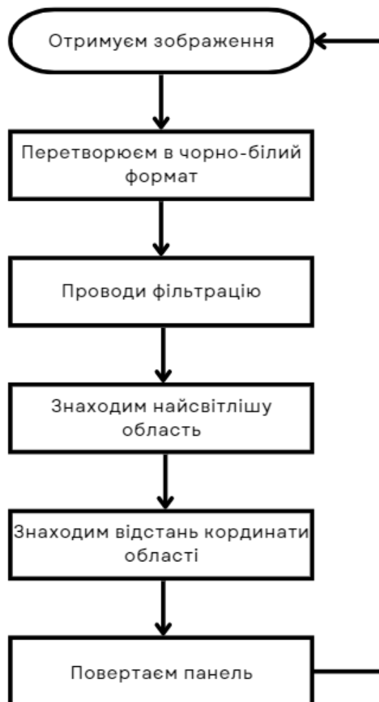
Рисунок 3.1 – Алгоритм роботи основного методу слідкування за сонцем
