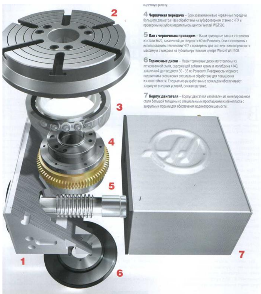
Рисунок 1.3. Кінематика ділильно-поворотного столу
