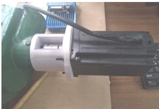
Рисунок 2.1 – Фотографія вузла встановлення шагового двигуна
