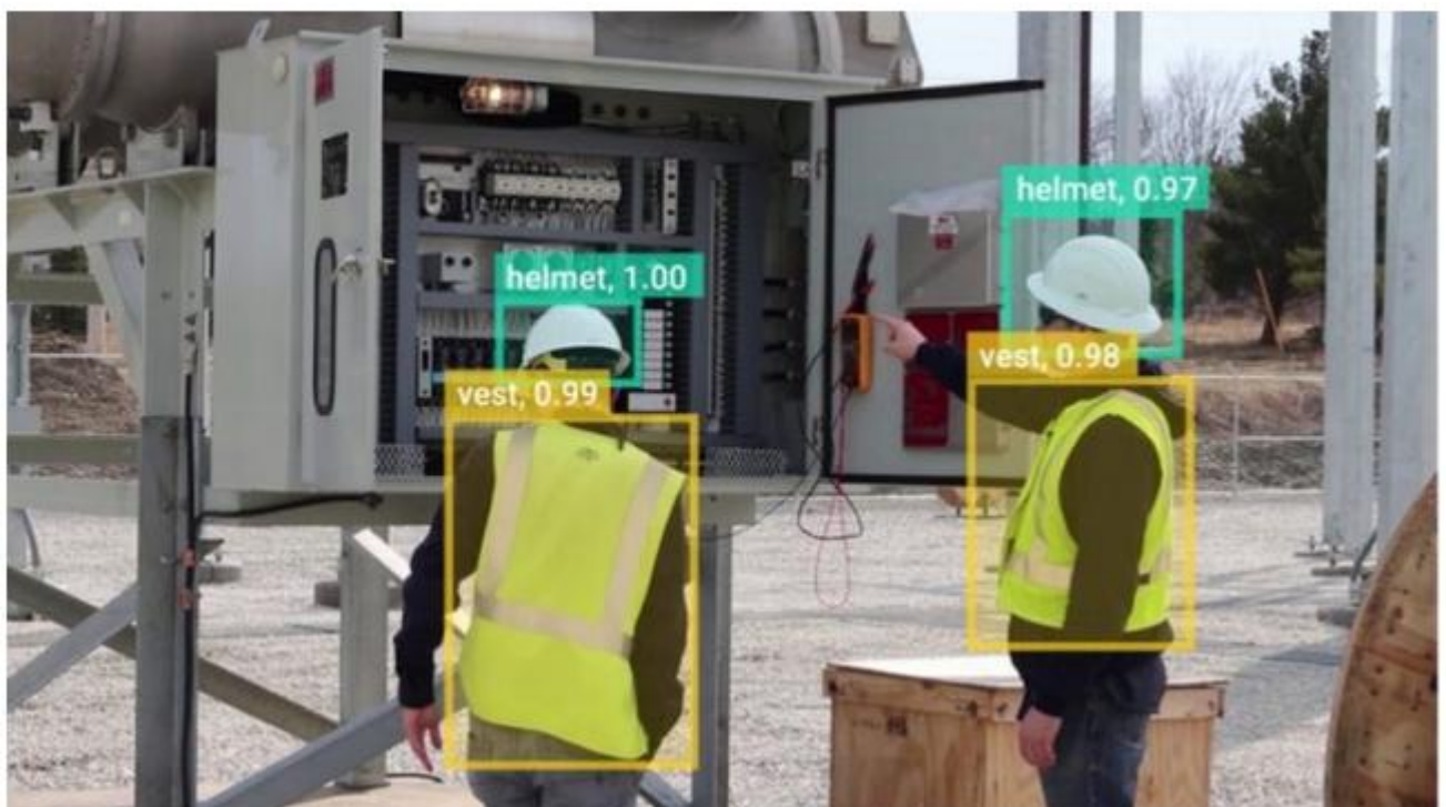
Рисунок 1.3 – Виявлення ЗІЗ за допомогою технології комп’ютерного зору [14]
