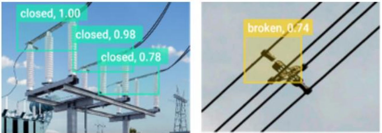
Рисунок 1.2 – Виявлення сторонніх об’єктів у лініях електропередачі [14]
