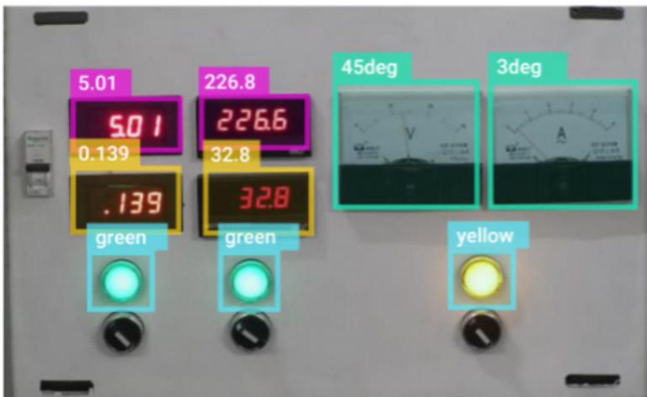
Рисунок 1.1 – Виявлення стану перемикачів для промислового електричного обладнання [14]
