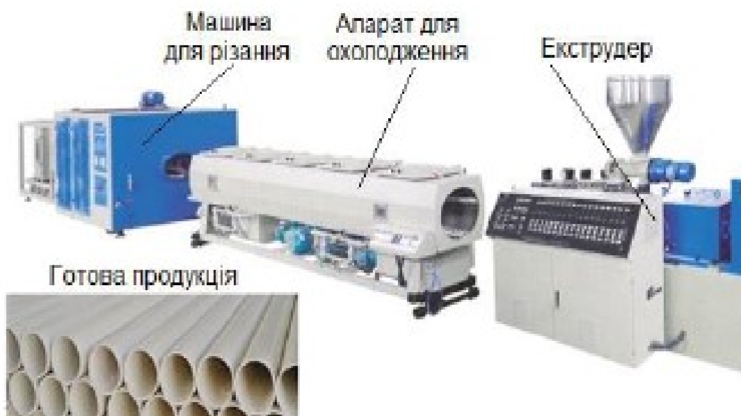
Рис.1.2 – Екструзійна лінія для виготовлення ПВХ труб
