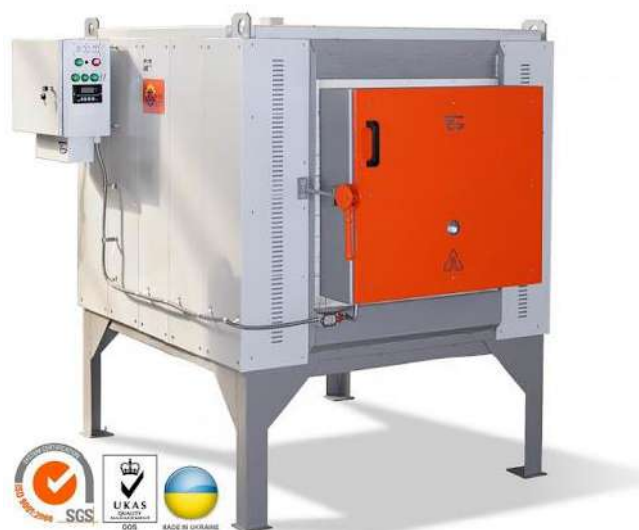
Рисунок 3.7– Електропеч для термічної обробки СНО-4.8.3/12,5
