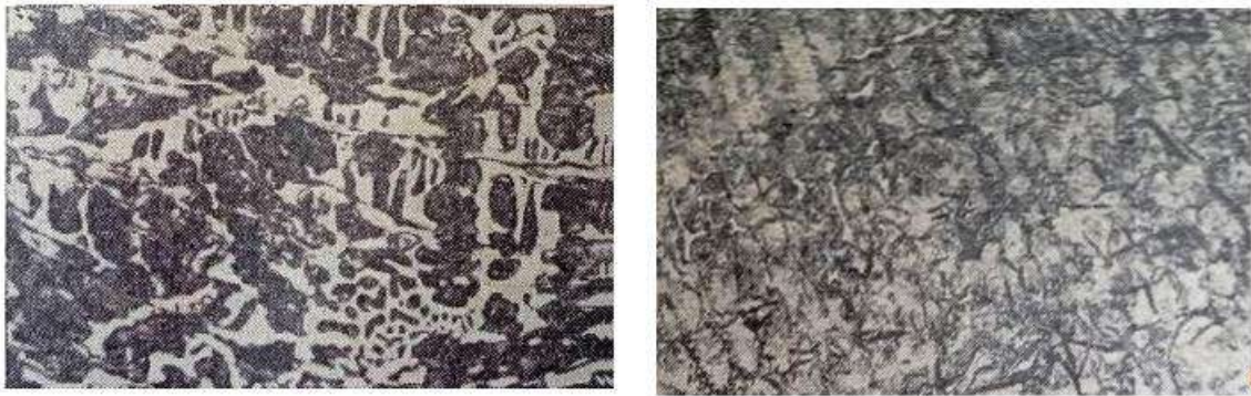
Рисунок 3.5 - Структура сірого чавуну : а) до модифікування; б) модифікованого
