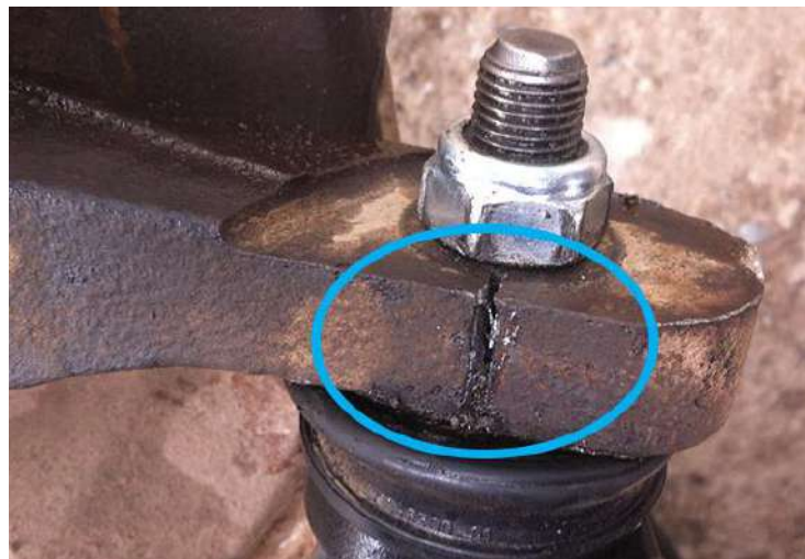
Рисунок 1.2 - Поворотний кулак з тріщиною
