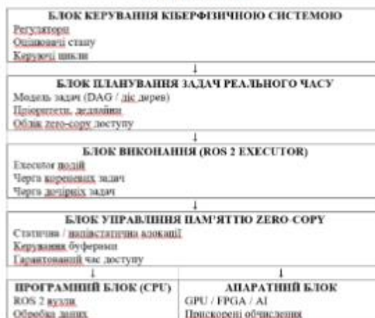
Рисунк 2 – Укрупнена блок-схема засобів реалізації методу планування процесів реального часу в кіберфізичній системі з підтримкою zero-copy доступу до пам'яті апаратних прискорювачів
