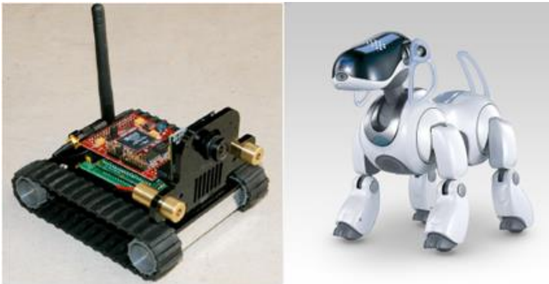
Рисунок 1.2 – Основні типи приводів роботів, що є мобільними: а) мото-колеса; б) робо-ноги.
