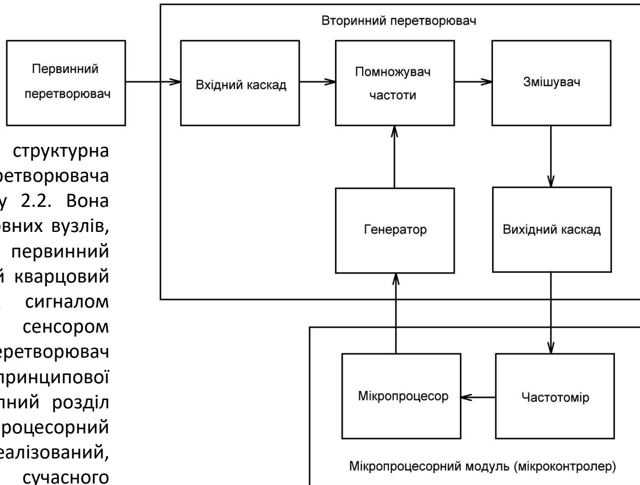
Рисунок 2.2 – Схема електрична структурна вимірювального перетворювача тиску
