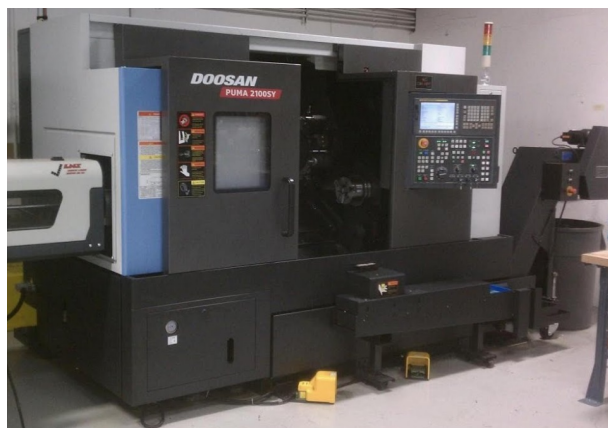
Рисунок 2.3 – Токарно-револьверний верстат з ЧПУ моделі Doosan PUMA 2100S
