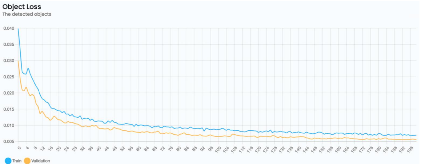
Рисунок В.3 – Навчання версії YOLOv5n на наборі даних UXOTi_NPA (проблема виявлення одинадцяти класів UXO): втрата об'єкта щодо епохи для навчальних наборів (синій) та перевірки (помаранчевий)
