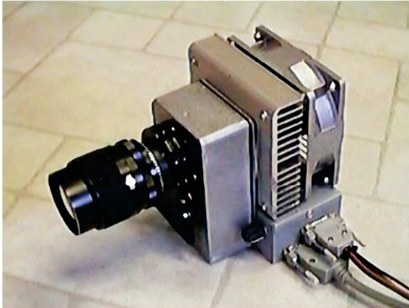
Рисунок 1.6 – Охолоджувач для фотокамер, сенсорів, наукових детекторів
