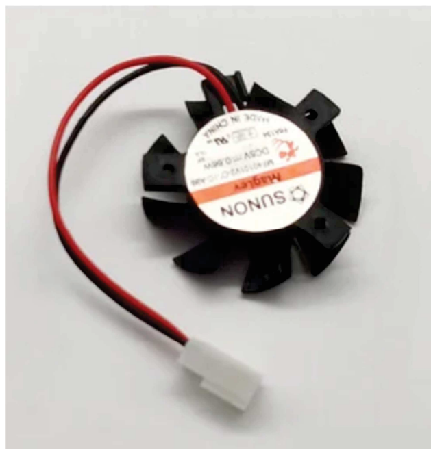
Рисунок 3.8 – Вентилятор холодної сторони
