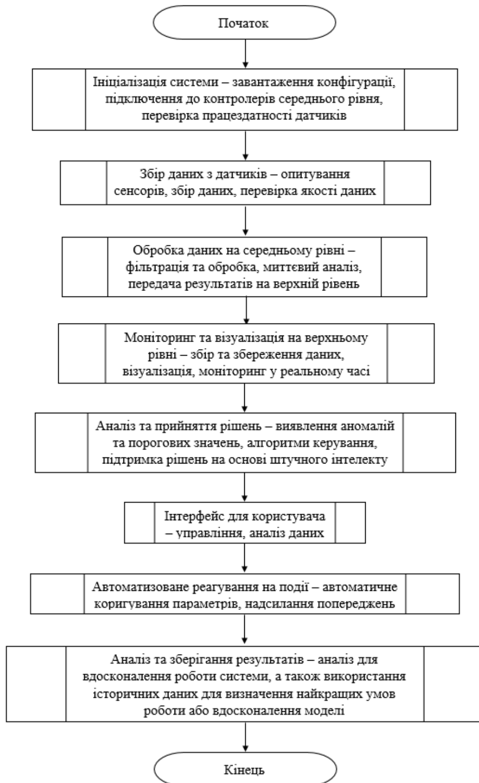
Рисунок 3.1 – Блок-схема узагальненого алгоритму збору, моніторингу та керування даними кіберфізичної системи визначення параметрів ґрунту
