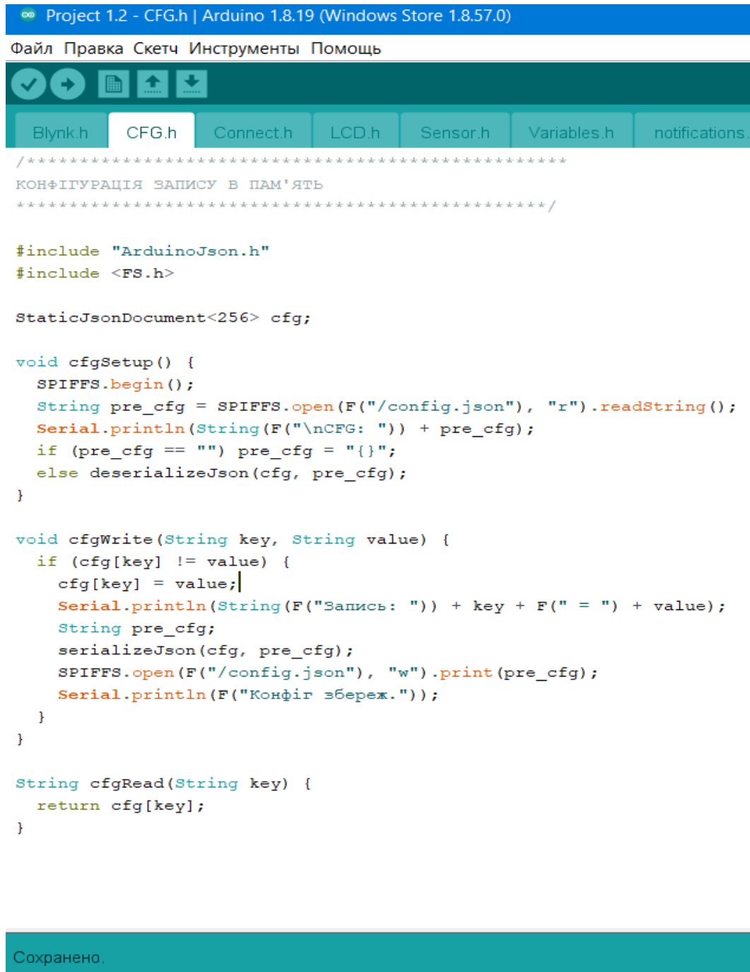
Рисунок 3.12 – Налаштування та збереження конфігурації мікроконтролера ESP8266 у вікні середовища програми Arduino ide
