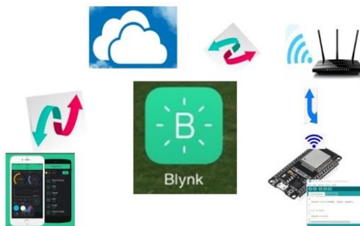
Рисунок 3.1 – Принцип взаємодії між собою IoT пристроїв та їх підключення до сервісу Blynk IoT
