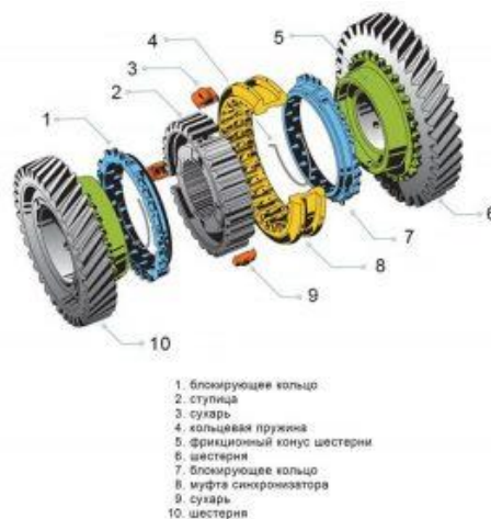
Рисунок Б.17 – Синхронізатор коробки передач
