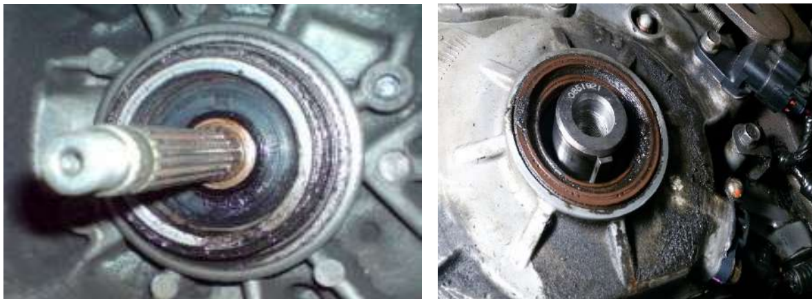
Рис. 3.3. Фрагменти розгерметизації вузлів ущільнення в приводах двигуна
