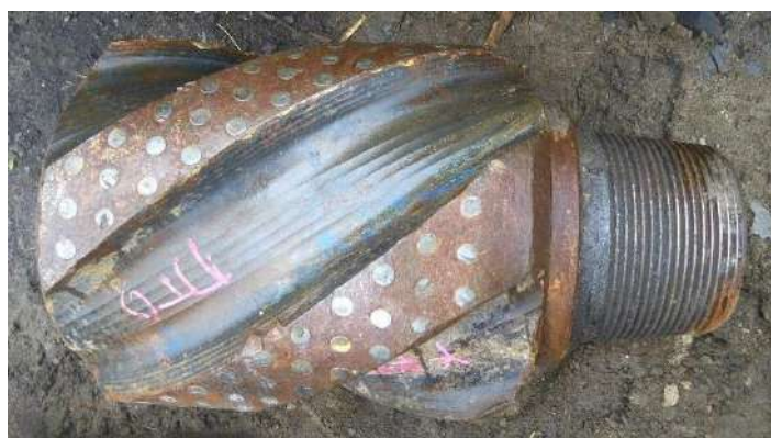
Рис. 17 – Фрагмент калібратора після руйнування, \times 0,13
