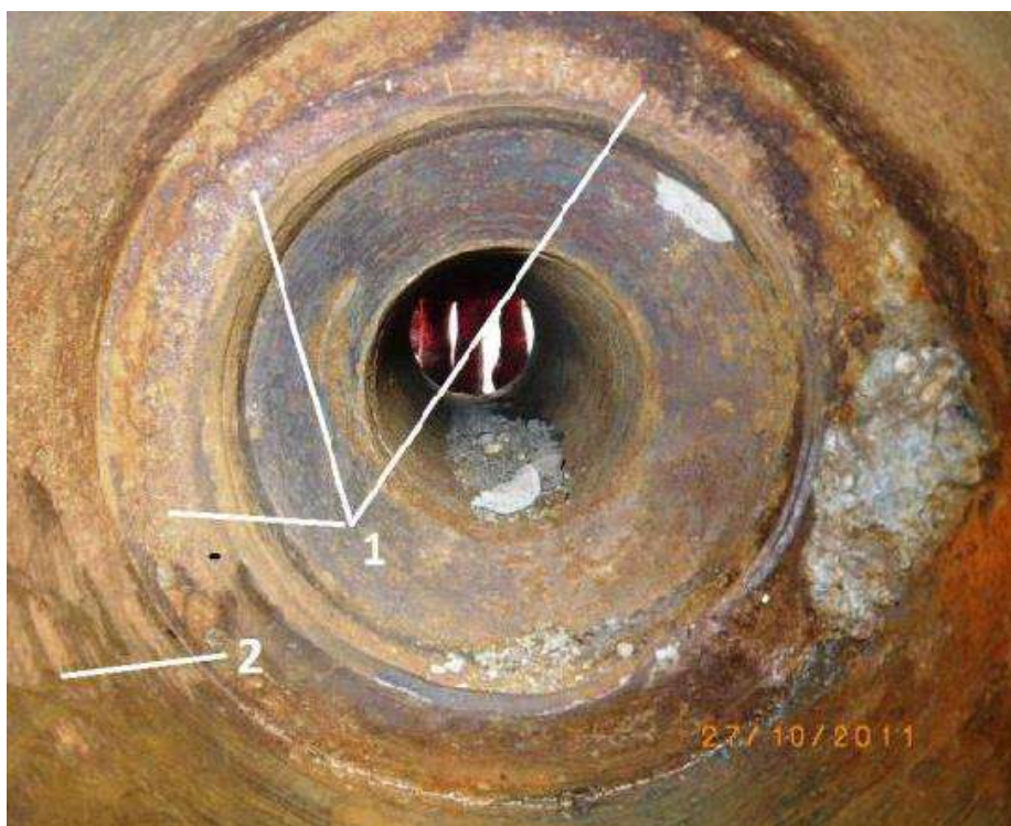
Рис. 18 – Вид калібратора руйнування, \times 4,6 . Поверхня руйнування зі слідами значної пластичної деформації: 1 – поверхня руйнування валу; 2 – внутрішня поверхня корпусу калібратора
