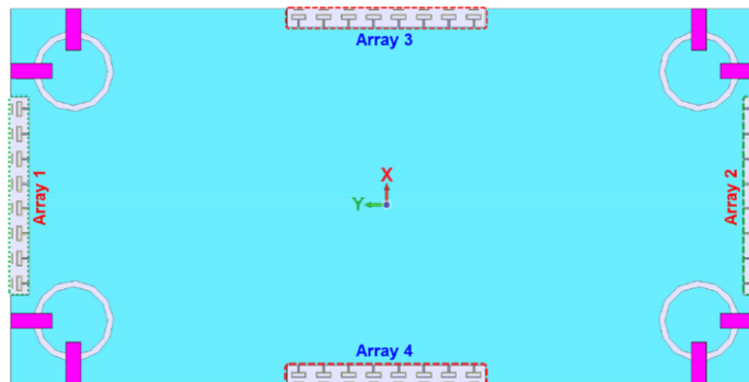
Рисунок 4.26 – Різні варіанти розміщення запропонованої фазованої антенної решітки мм-хвиль на друкованій платі смартфона
