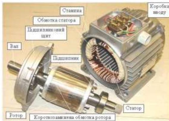
Рисунок 1.12 - Асинхронний електричний двигун у розібраному вигляді
