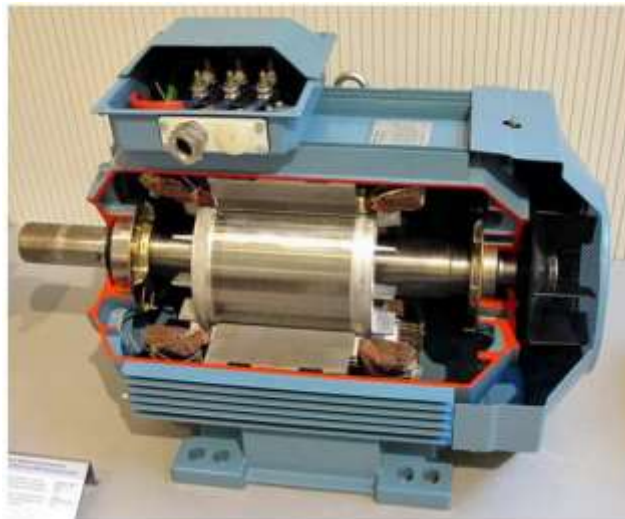
Рисунок 1.11 - Асинхронний двигун (розрізано)
