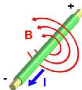
Рисунок 1.3 - Виникнення магнітного поля навколо провідника зі струмом
