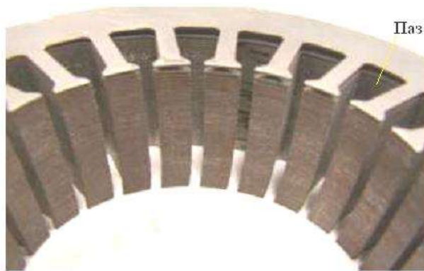
Рисунок 1.5 - Магнітопровід статора електричного двигуна змінного струму
