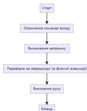
Рисунк 2.9 – Алгоритм роботи MovementController
