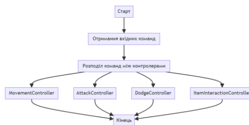
Рисунок 2.13 – Блок-схема взаємозв'язків контролерів
