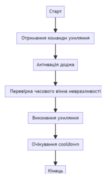
Рисунок 2.11 – Алгоритм роботи DodgeController
