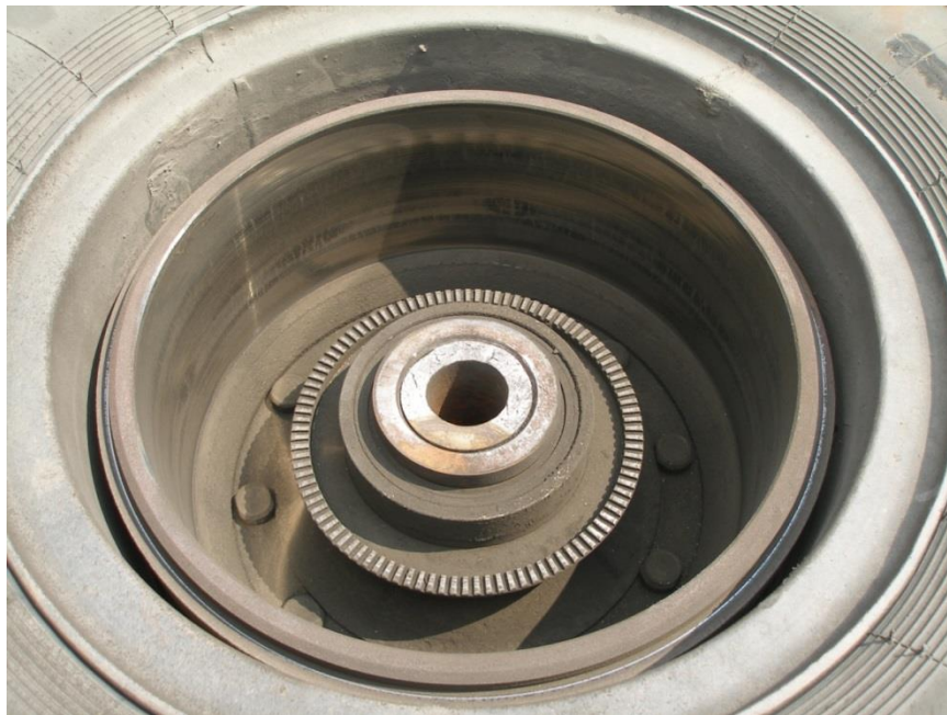
Рис. А.1. Фотографія зламу вісі правих передніх коліс напівпричепа «МАЗ 9530-010»
