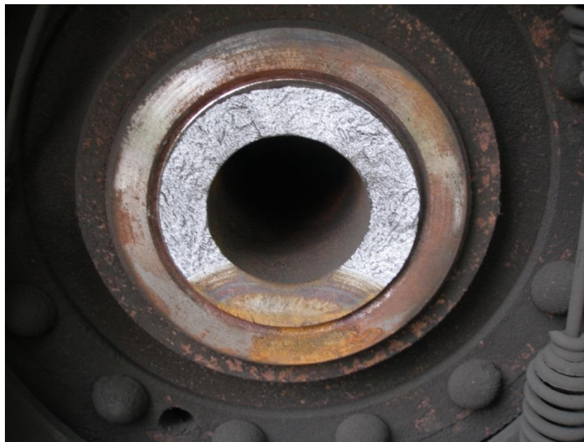
Рис. А 3. Фотографія вигляду зламу вісі правих передніх коліс напівпричепа «МАЗ 9530-010» та розвитку втомленої тріщини (вид на гальмівний щит)
