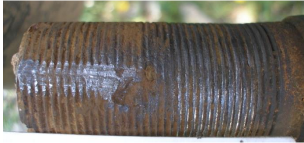
Рис. 1.3. Фотографія детального вигляду пошкодження різьбової частини петлі причепа до автомобіля ЗІЛ-131
