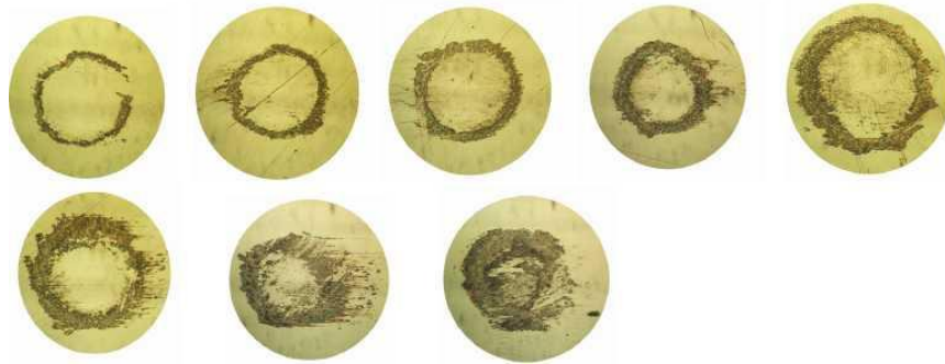
Рис. 4.4. Фотографія зміни ушкоджень зони контакту зразка при коливаннях за схемою металевої кульки (Ø 12,7 мм)
