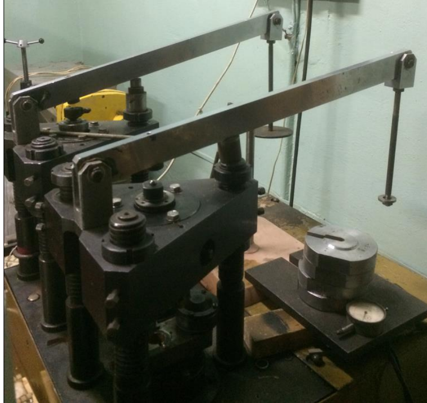
Рис. 2.2. Фотографія установки для дослідження на фретинг-зношування
