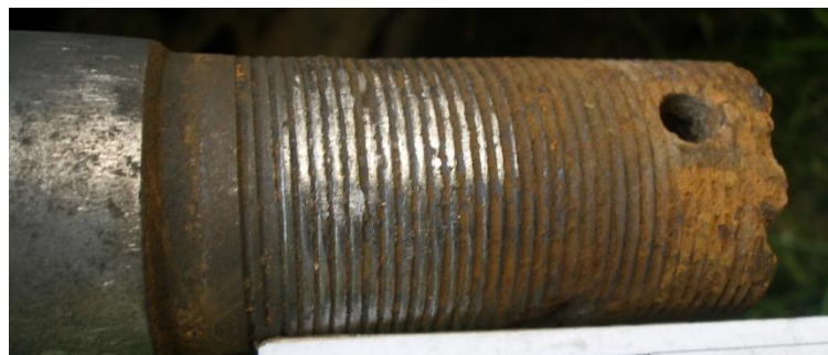
Рис. 1.4. Фотографія детального вигляду пошкодження різьбової частини петлі причепа до автомобіля ЗІЛ-131
