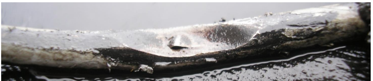
Рис. А.7. Фотографія потоншення та розриву поверхні металевого трубопроводу гальмівного механізму задніх правих коліс після силового та корозійного впливу
