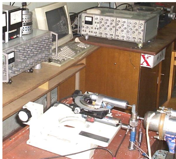
Рис. 2.6. Фотографія загального вигляду установки для дослідження стану фрикційного контакту при малоамплітудному фретингу
