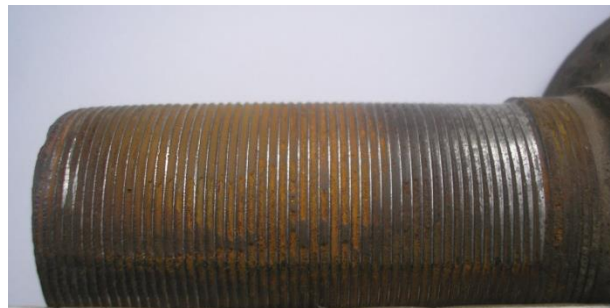
Рис. 1.2. Фотографія детального вигляду пошкодження різьбової частини наконечника лівої штанги передньої підвіски автобуса «Ікарус»
