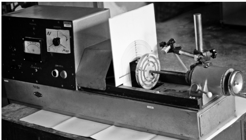
Рис. 5. Експериментальна установка для демонстрації критичних обертів вала
