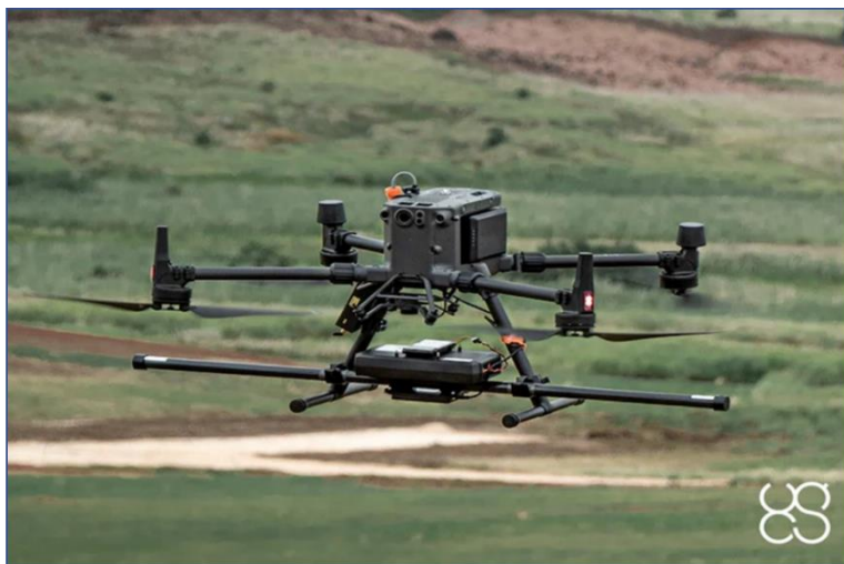
Рисунок 3.3 – Характеристики та зображення дрона DJI Matrice 300 RTK та магнітометра DJI Matrice 300 RTK [2, 8]
