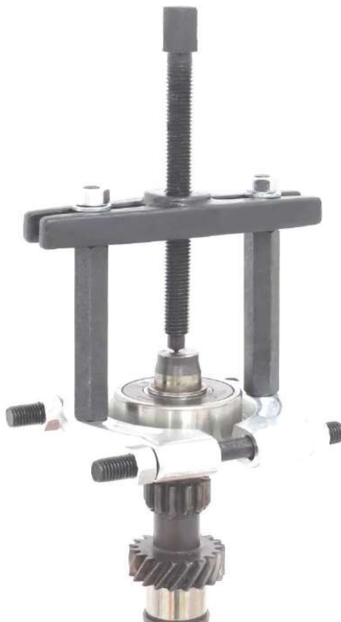
Рисунок 2.2 – Інструмент 601094869547 для знімання підшипників КШ
