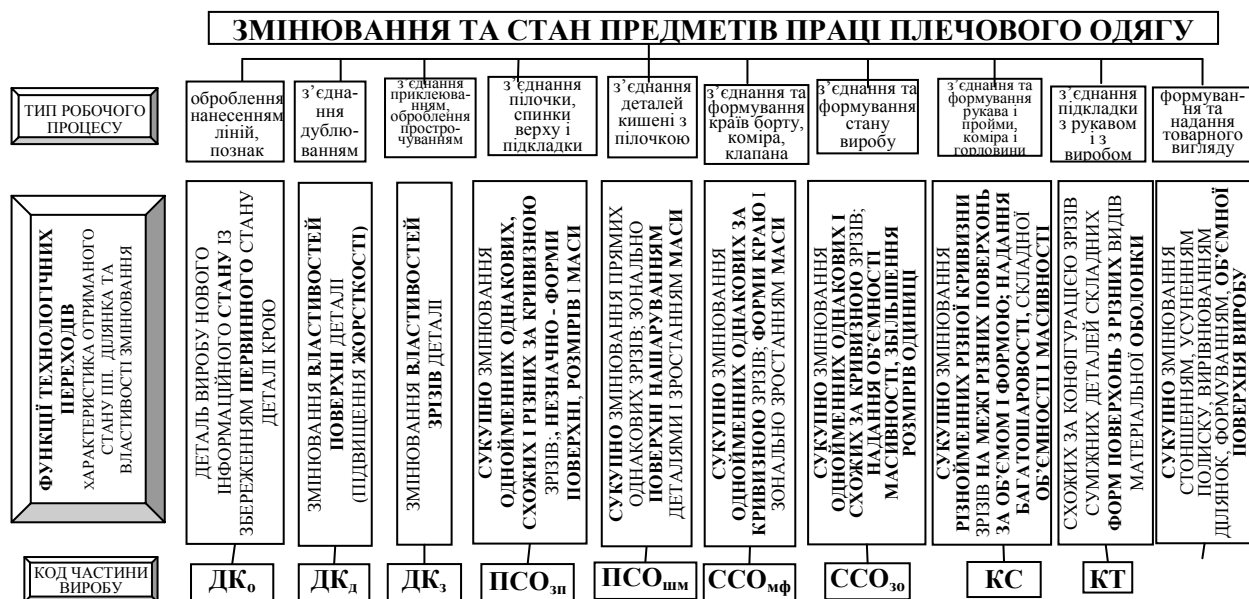
Рис. 2. Ступені змінювання станів предметів праці за функціями технологічних переходів в процесі пошиття виробу
