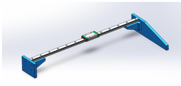
Рисунок 2.13 – Рейкова лінійна направляюча, що виконує роль несучого елемента порталу та високоточної напрямної переміщення каретки по осі X
