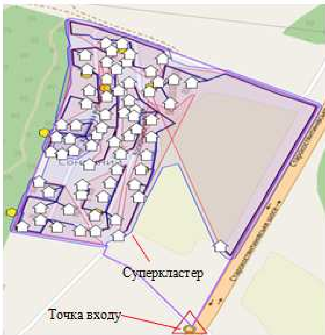
Рисунок 2.5 – Схема об'єднання кластерів в суперкластери
