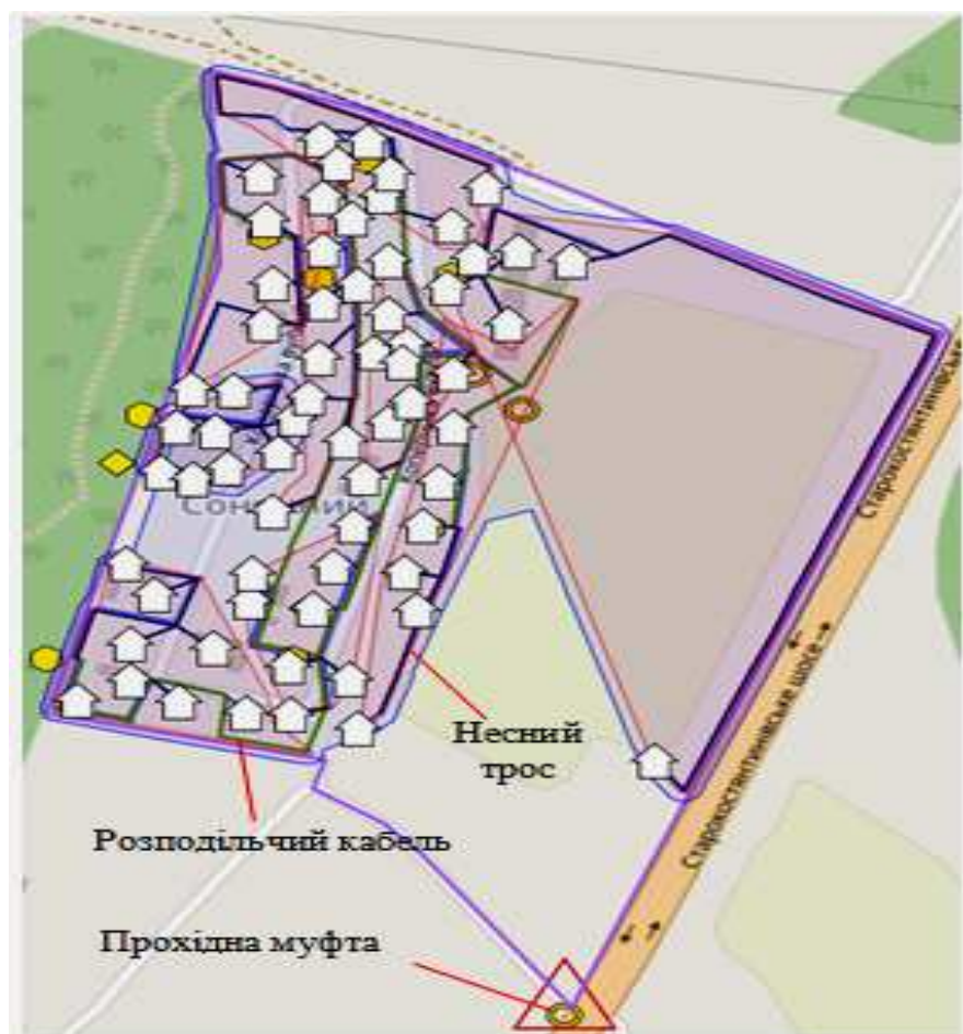
Рисунок 2.6 – Схема встановлення розподільчого пристрою першого каскаду та підключення кластерів
