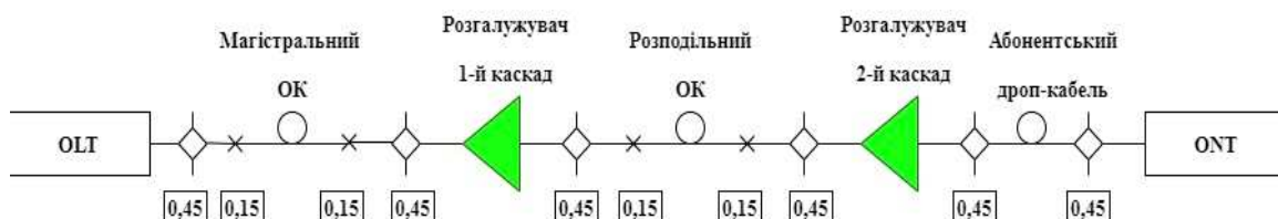
Рисунок 2.16 – Лінійна схема OLT – ONT із зазначенням втрат (дБ) на з'єднаннях
