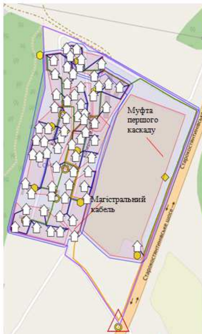
Рисунок 2.6 – Схема прокладання магістрального кабелю
