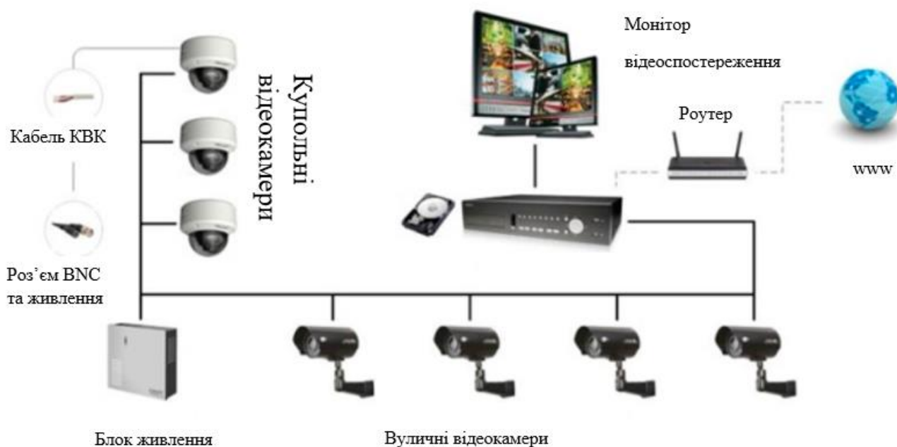
Рисунок 1.1 – Схема побудови типової аналогової системи відеоспостереження
