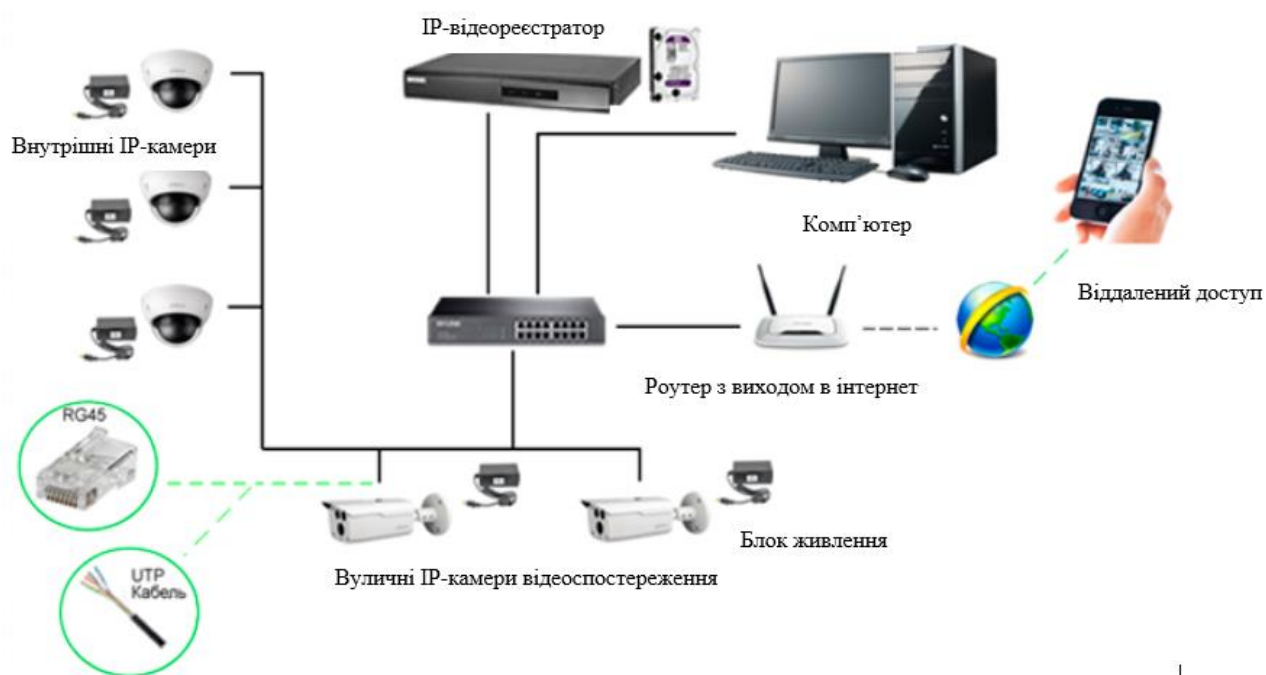
Рисунок 1.3 – Компоненти та порядок з'єднань компонентів IP-систем відеоспостереження
