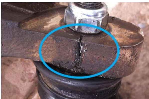
Рисунок 2.3 – Тріщина поворотного кулака
