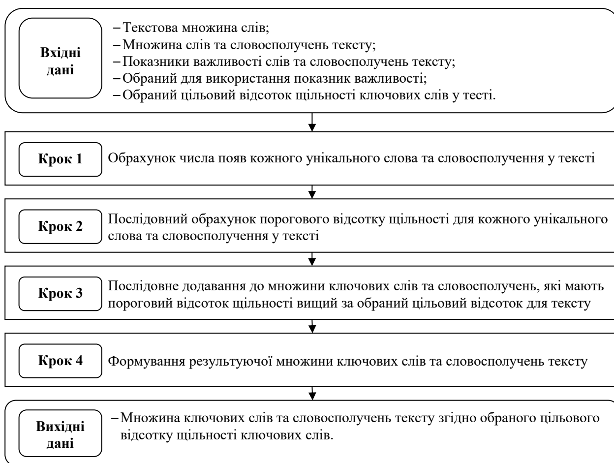
Рисунок 2.1 – Схема методу автоматизованого формування семантичного ядра цифрових текстів
