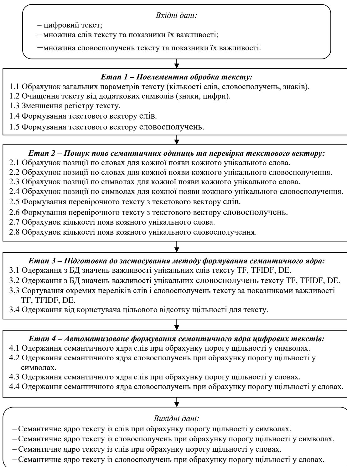
Рисунок 3.2 – Схема інформаційної технології автоматизованого формування множини ключових семантичних одиниць
