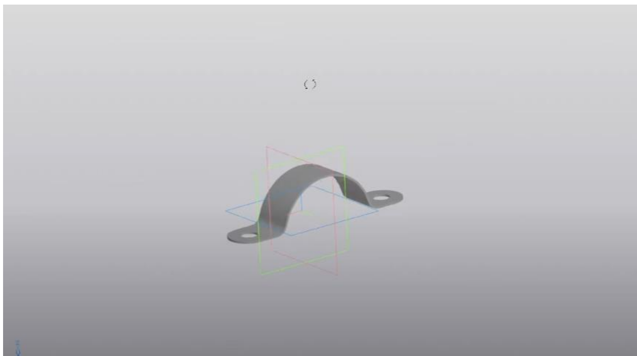
Рисунок 14 – Кінцевий результат листової деталі у програмі Компас-3D
