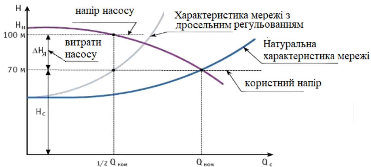
Рисунок 3.9 – Характеристики насосного агрегату і мережі з дросельним регулюванням
