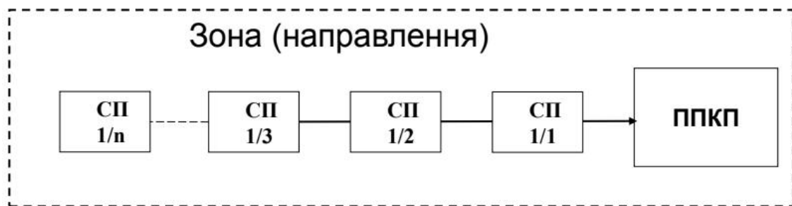
Рисунок 1.5 – Зона (направлення) системи автоматичного пожежогасіння
