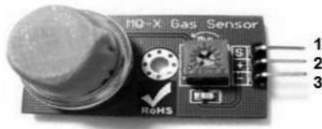
Рисунок 3.4 – Конфігурація датчику диму MQ-2 (1 – вивід; 2 – Vcc; 3 - Gnd)
