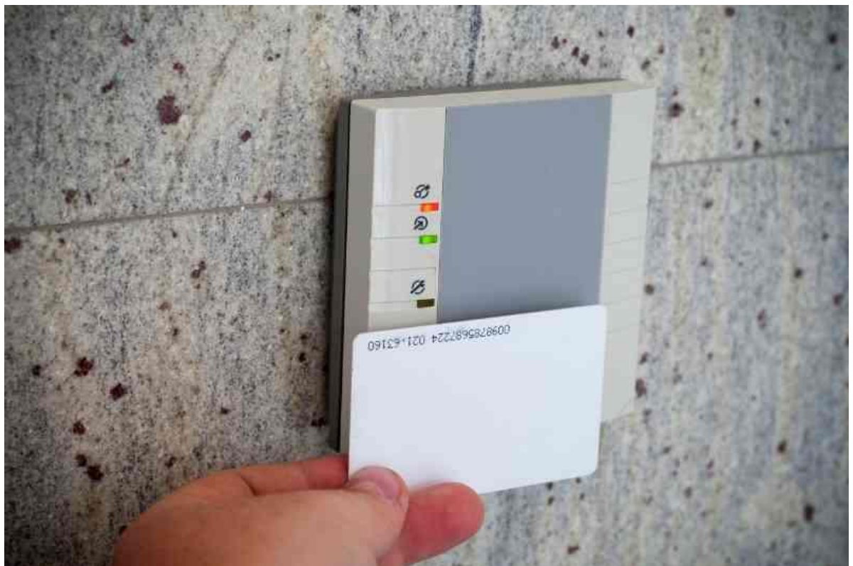
Рисунок 1.1 – Система доступу до дверей на основі картки
