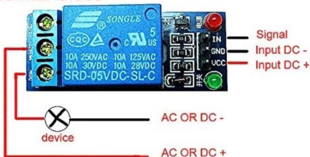
Рисунок 2.7 – Релейний модуль SRD-05VDC-SL-C та підключення контактів до NO та NC відповідно
