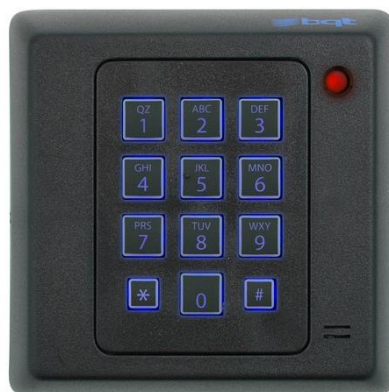
Рисунок 1.2 – Система доступу до дверей на основі клавіатури
