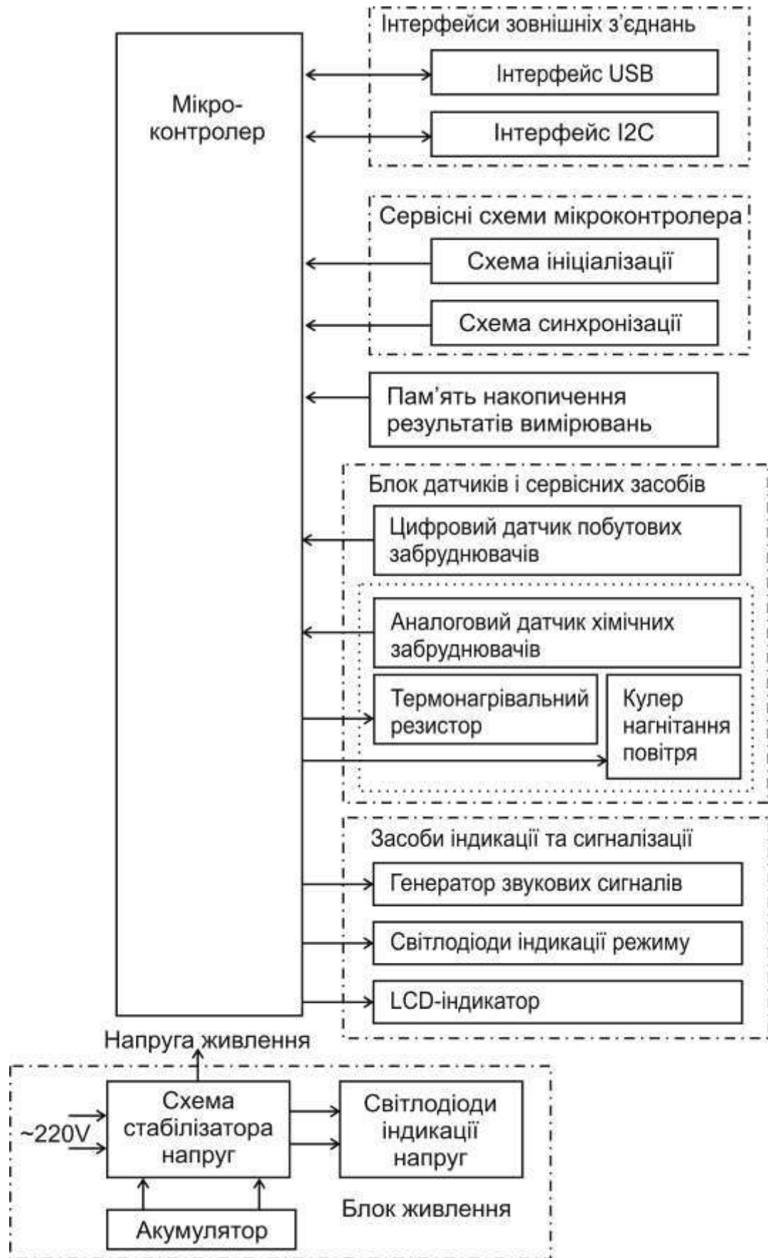
Рисунок 3.1 – Схема електрична структурна контролера-аналізатора забрудненості атмосферного повітря
