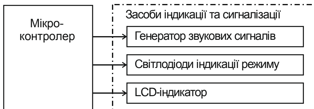
Рисунок 3.6 – Реалізація підсистеми засобів індикації та сигналізації на схемі електричній структурній контролера-аналізатора
